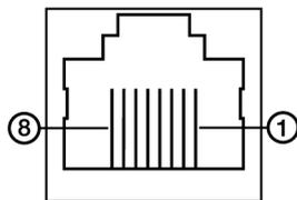
Рис. 8. Разъём CONSOLE
