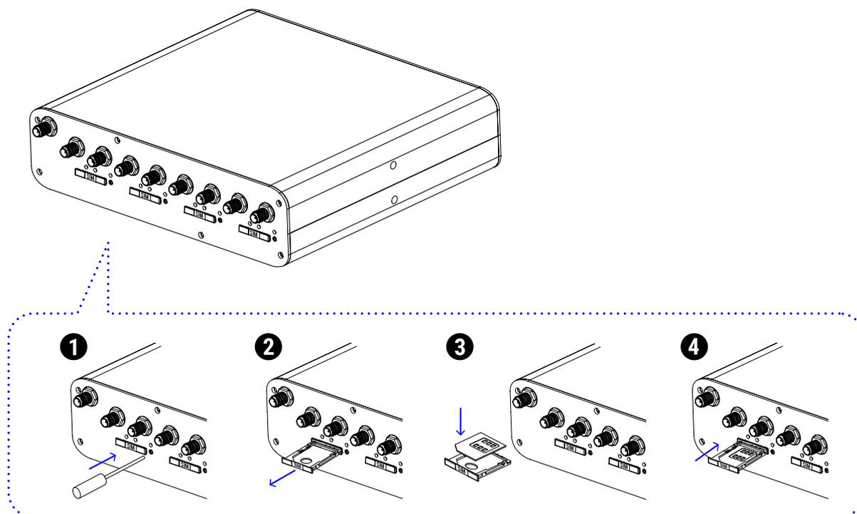
Рис. 9. Установка SIM-карт
