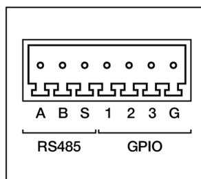
Рис. 7. Интерфейсный разъём
