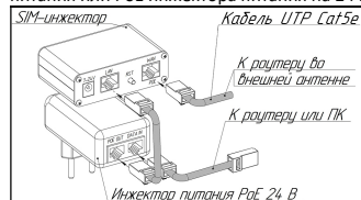
Схема 2 – PoE подключение SIM-инжектора
