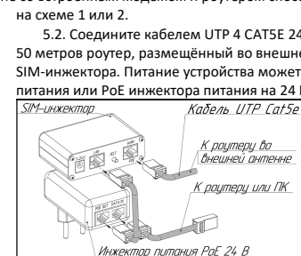
Схема 2 – PoE подключение SIM-инжектора
